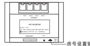
步骤3:连续输入5位编码,如设1端口房为0001号,连续输入10001#,操作成功主机提示“PASS”可连续设置下一端口,2端口20002#,3端口30003,4端口40004#,完成设置解码器按T1键退出,编码状态主机可连续设置多个解码器。
